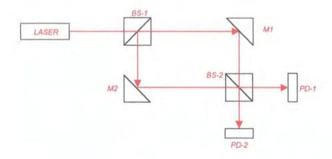
Figure 5.1. Mach-Zehnder Interferometer.
