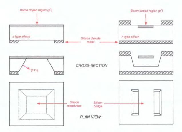
Figure 2.2. Boron etch stop technique.
