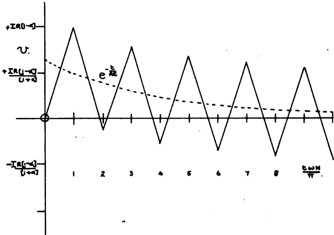
FIG. 3 VOLTAGE WAVEFORM ACROSS C. ( $\alpha \gg 1$ ).
