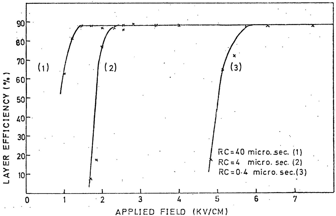
FIGURE 3 EFFICIENCY VERSUS RISE TIME
