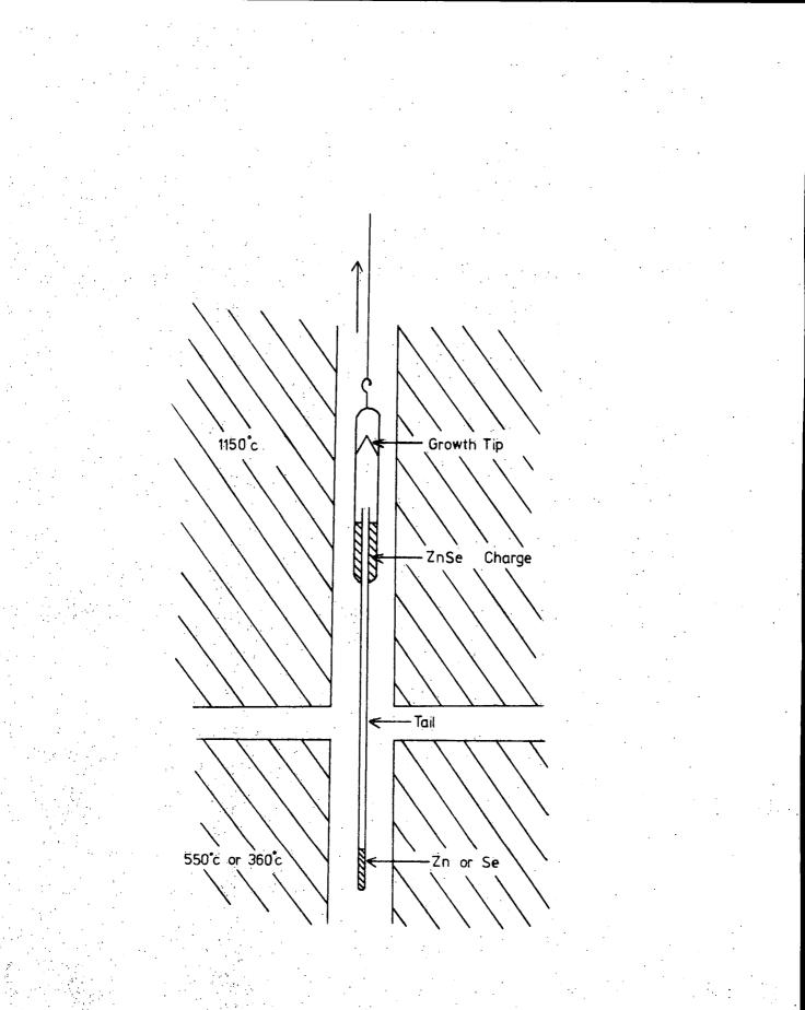
Fig. 3-1. Vapour Phase Transport Crystal Growth System.
