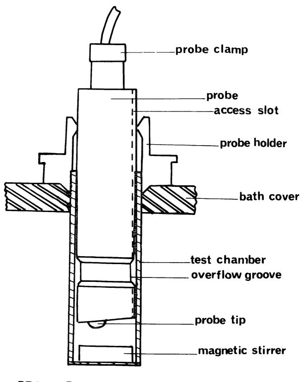
PROBE, PLUNGER & SAMPLE CHAMBER
