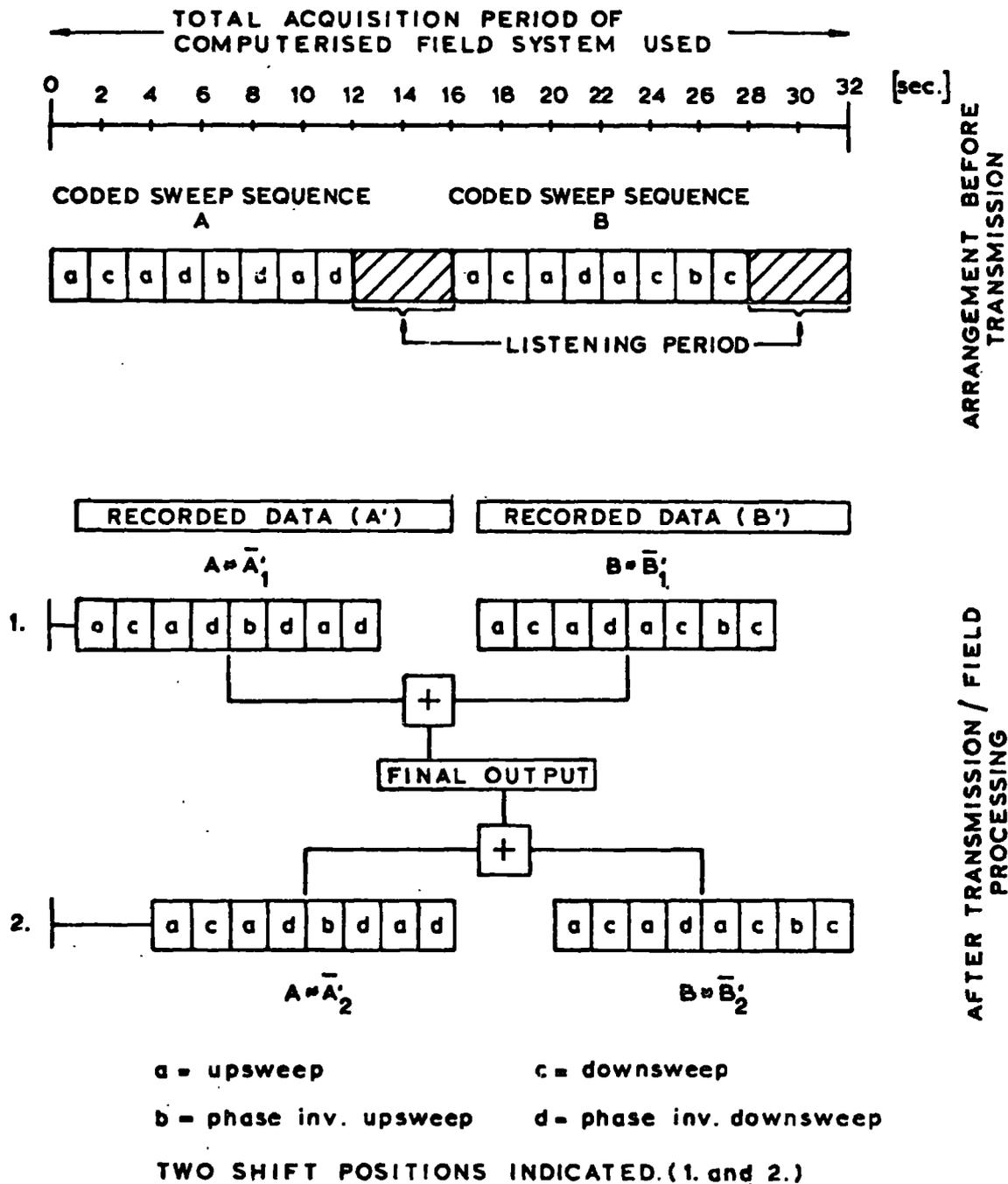
FIG.46 - FIELD IMPLEMENTATION OF VIBROSEIS ENCODING TECHNIQUE
