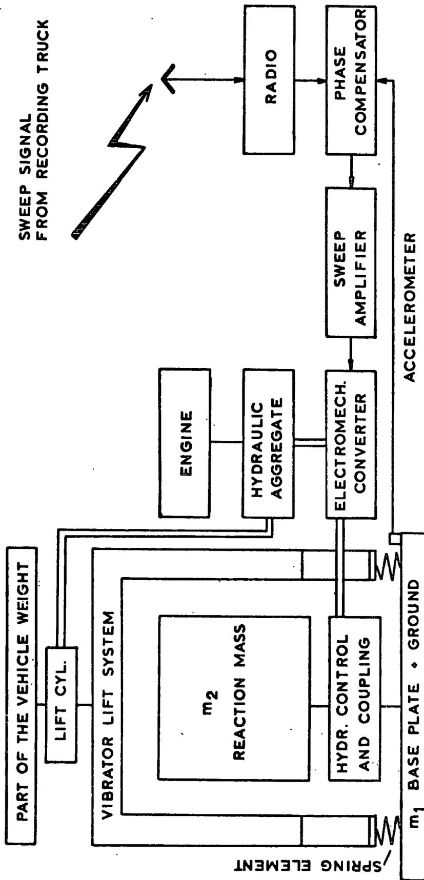
FIG. 52 - VIBRATOR PRINCIPLE
