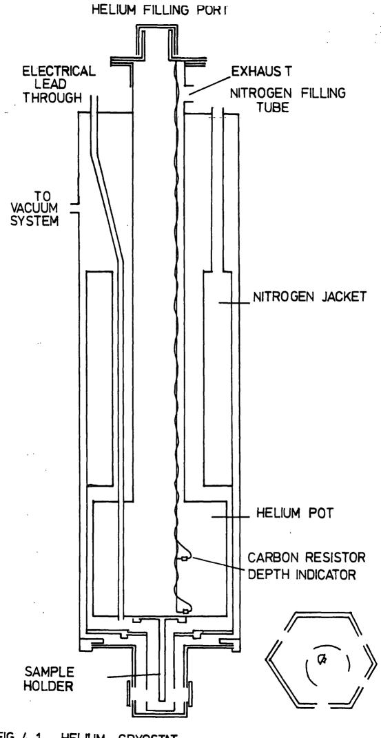
FIG 4.1 HELIUM CRYOSTAT
