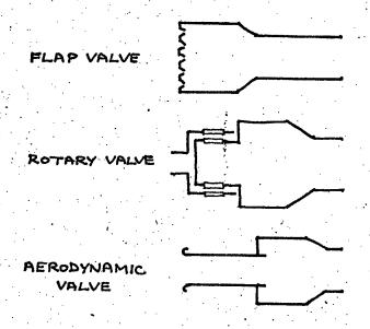
FIGURE 1.12 : MECHANICAL AND AERODYNAMIC VALVES
