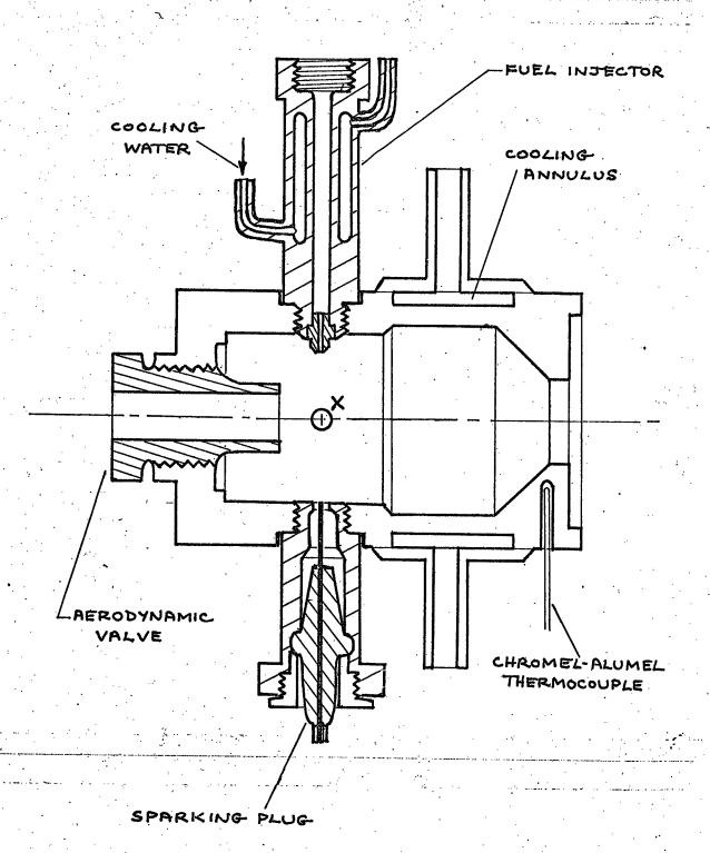
FIGURE 3.3 : COMBUSTION CHAMBER
