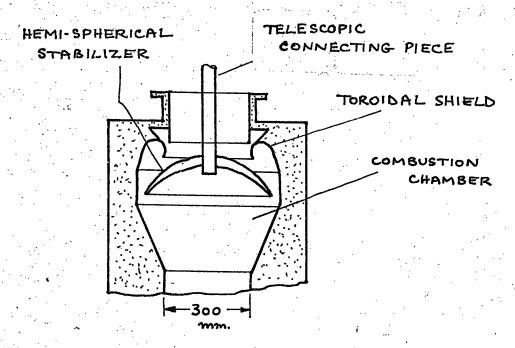
FIGURE 1.13 : AERODYNAMIC VALVE OF BABKIN
