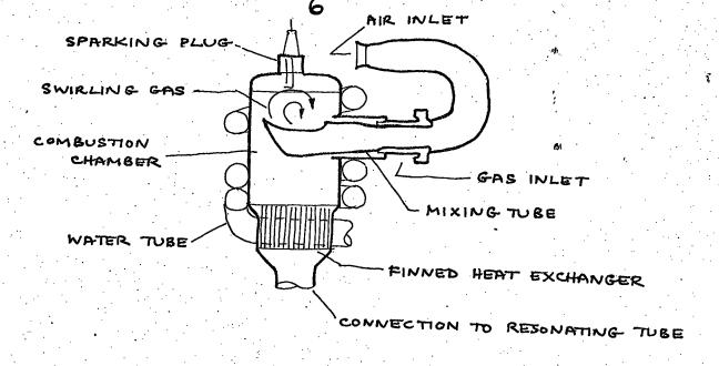
FIGURE 14 : HUBER COMBUSTION CHAMBER
