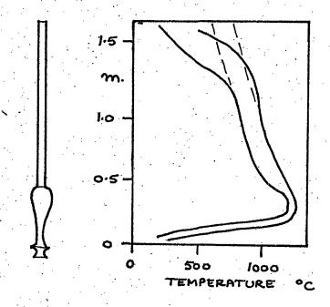
FIGURE 1.9 : GAS TEMPERATURE DISTRIBUTION
