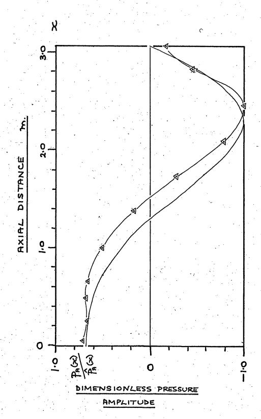
FIGURE 4.17: AXIAL DISTRIBUTION OF PRESSURE
