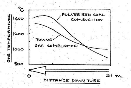
FIGURE 1.17 : GAS TEMPERATURE DISTRIBUTION
