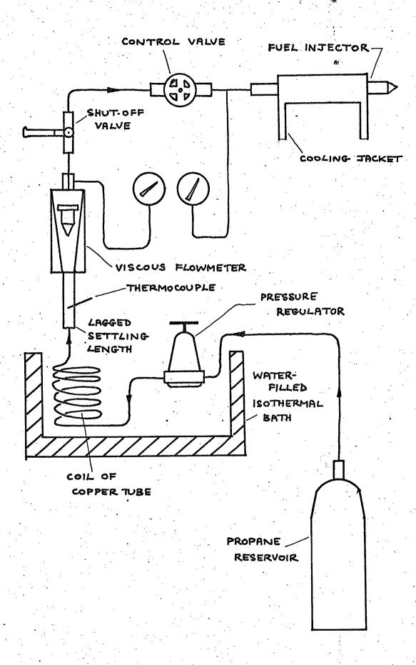
FIGURE 3.7: LAY-OUT OF FUEL SYSTEM
