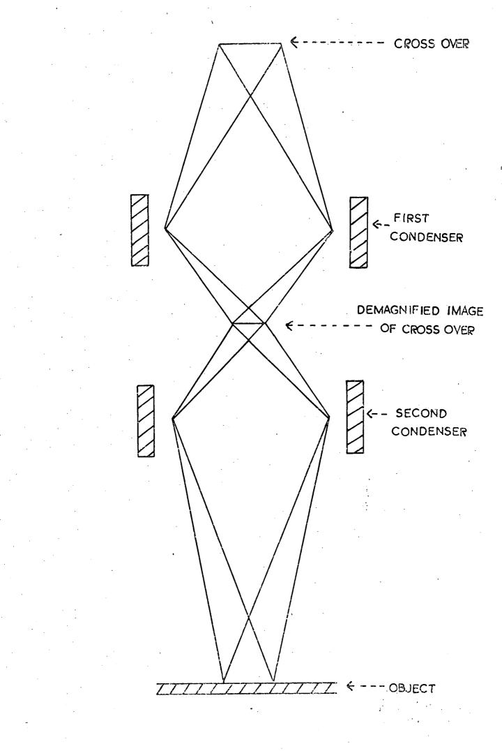
FIGURE 2.3 THE CONDENSER SYSTEM
