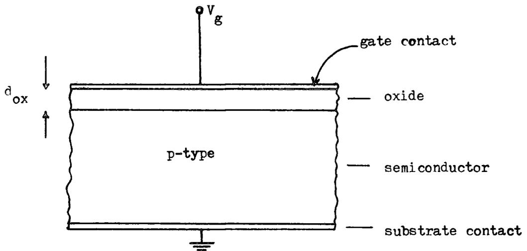
Fig. 2.1 : MOS capacitor structure,
