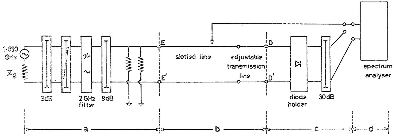
FIG. 5.2 BLOCK DIAGRAM FOR THE COMPLETE COAXIAL LINE SYSTEM
