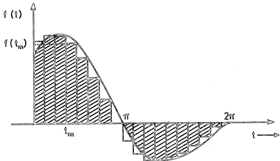
FIG. 3-1 ARBITRARY WAVEFORM TO BE ANALYSED
