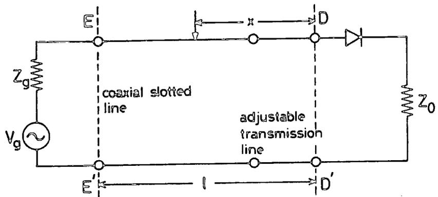
FIG.4.3 THE SLOTTED LINE CIRCUIT AT THE FUNDAMENTAL
