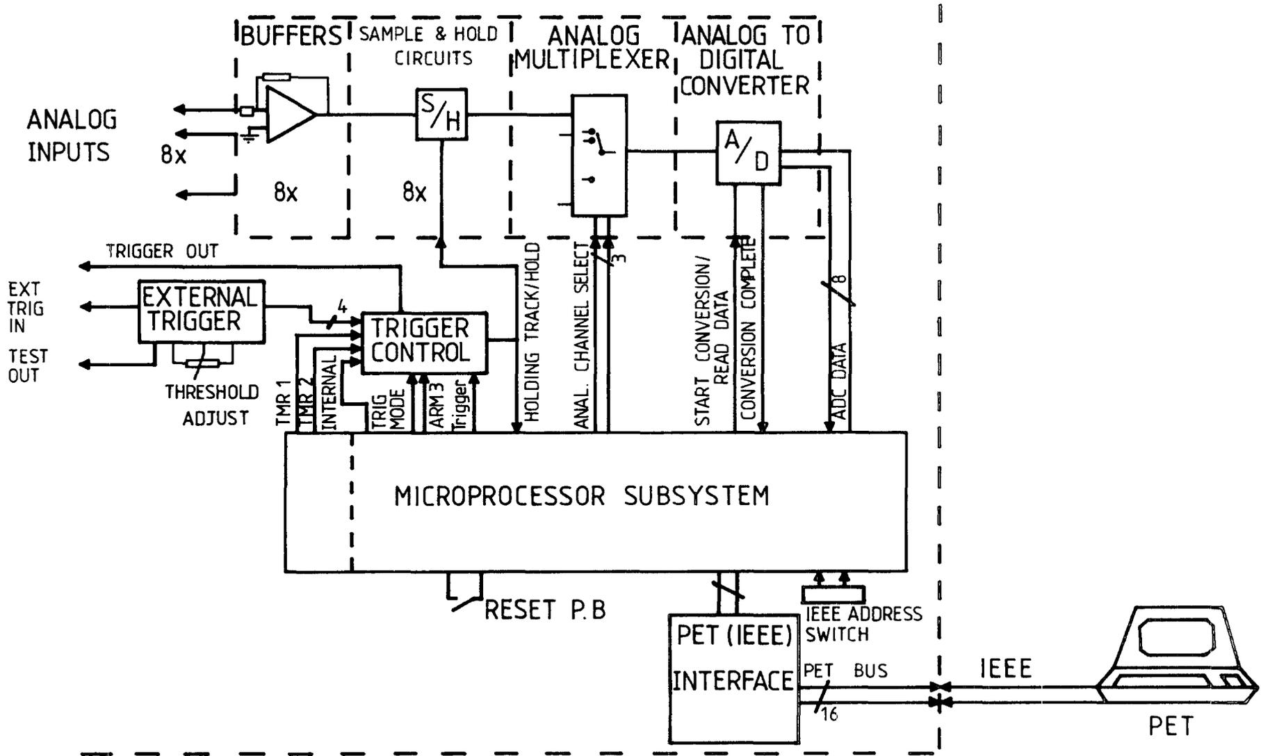
FIG. 2-1 PET DATA AQUISITION UNIT – BLOCK DIAGRAM
