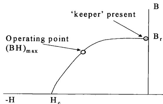
Fig. 4.3.2 Demagnetisation curve
