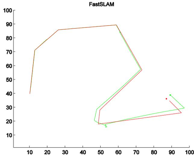
Figure 4.5 (d) FastSLAM with low odometry error
