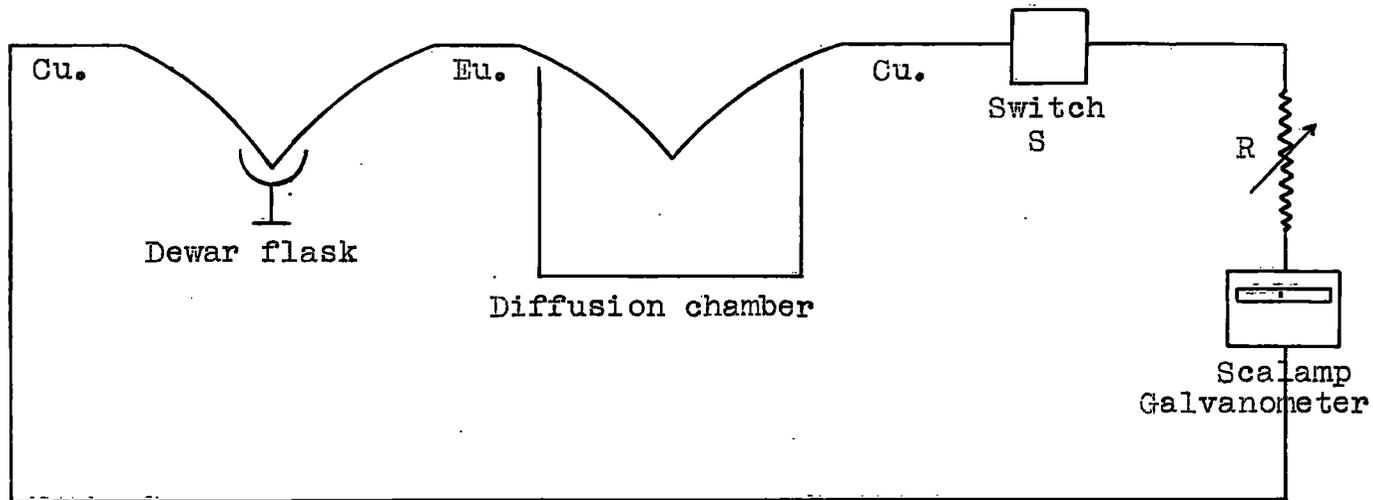
Fig. 4 Thermocouple Arrangement
